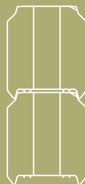
Вертикально-клееный брус (VLL) 88 x 180 mm 112 x 180 mm 134 x 180 mm 164 x 176 mm
